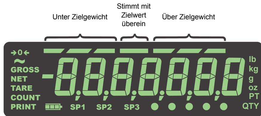
Abbildung 3.2 Kontrollwägung-Balkenanzeige
