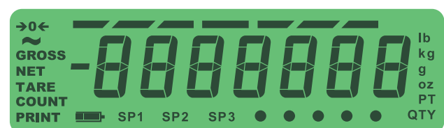
TN-Anzeige Ideal für die Verwendung in Außenbereichen (nur Waagen der Reihe ZM303)
