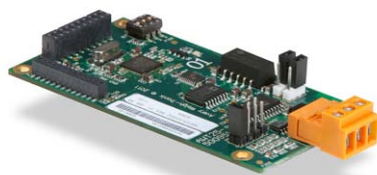
Tarjeta de salida analógica 0-10 VCC y 4-20 mA.
