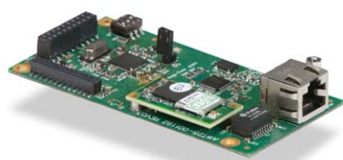
Tarjeta interna inalámbrica Inalámbrica 802.11b/g
