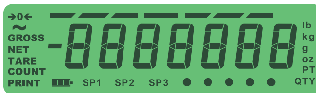
Pantalla TN Ideal para uso en exteriores (sólo para el modelo ZM303)
