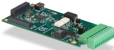
Carte de boucle de courant Boucle de courant/RS485/RS422.
