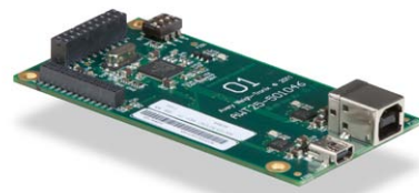
Carte de périphérique USB Assure une interface USB avec un ordinateur personnel.
