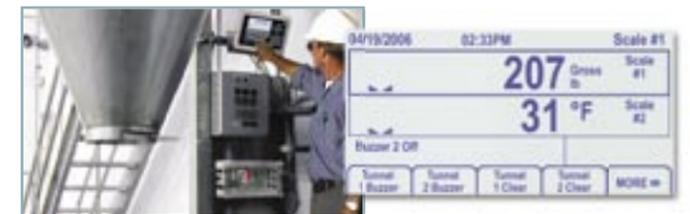
Visualización de dos básculas les da la opción de ver una o dos básculas a la vez. La entrada analógica y placa opcional les permite monitorear peso, temperatura u otros sensores simultáneamente.
