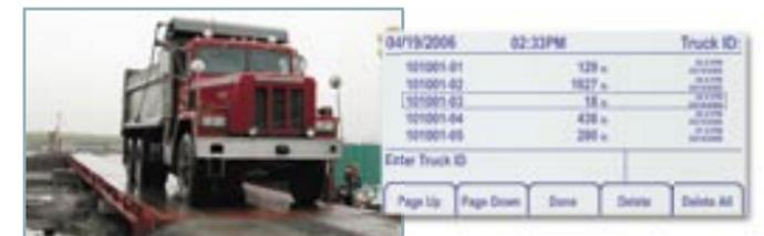
Almacenamiento de datos abordo les permite guardar, rastrear, y transmitir información de peso con su 820i. Software alibi les permite traer de memoria e imprimir transacciones previas.
