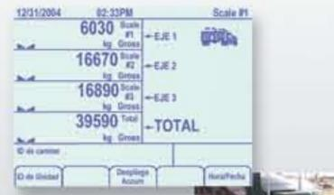
La capacidad de la pantalla permite visualizar el peso de 32 básculas en forma individual y la combinación de varios en suma.
